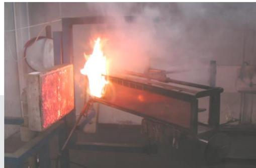
Test di resistenza al fuoco secondo la norma UNI 9796 (provino a sinistra = conforme, provino a destra= non in classe 1
