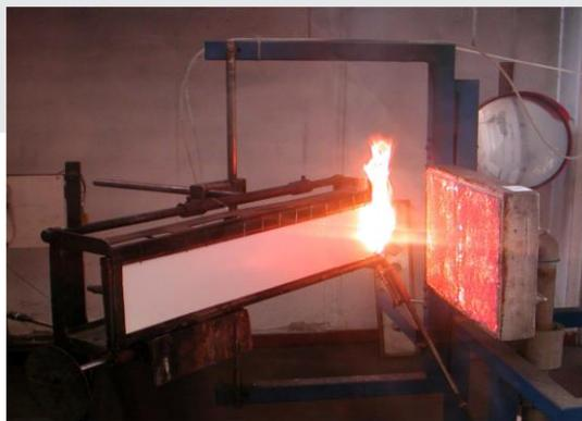
Test di resistenza al fuoco secondo la norma UNI
